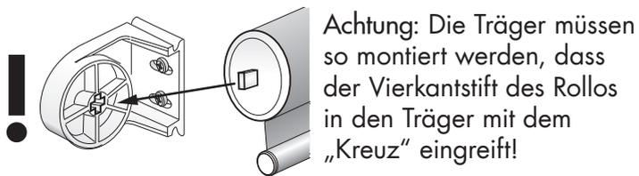
Achtung: Die Träger müssen so montiert werden, dass der Vierkantstift des Rollos in den Träger mit dem „Kreuz“ eingreift!
