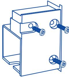
Befestigen Sie zuerst eine der beiden Halterungen am Fensterrahmen, oder Glasleiste, so das die Aussparung für 2 Bohrlöcher oben (unten 1 Bohrloch) und die große Fläche vorne ist. Dann stecken Sie die Jalousie in die Halterung hinein und schieben sie die zweite Halterung auf das noch verbliebene Ende der Oberleiste und befestigen auch diese am Fensterrahmen.
