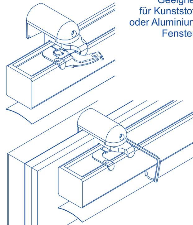
Befestigen Sie zunächst die Träger an der Schiene. Achten Sie unbedingt darauf, dass die Träger nicht über drehende Teile in der Schiene positioniert werden.
