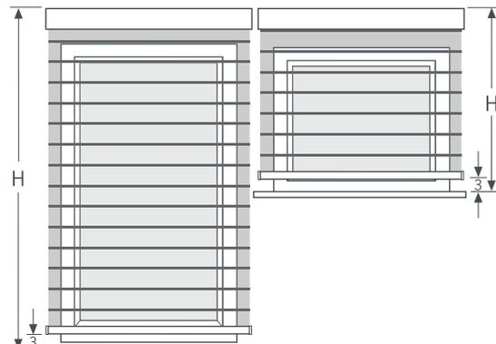
Beim Weiterziehen wird der Behang geöffnet, die Unterleiste ca. 30 mm angehoben.
