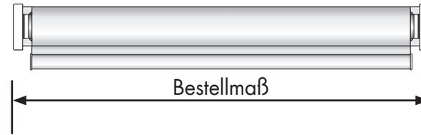
Das Außenmaß des Rollos anzeichnen. Dabei darauf achten, dass die Montageschiene in der Waage sein muss!
