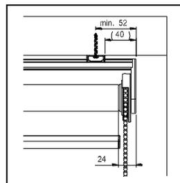
Die Montage erfolgt mittels der mitgelieferten Träger. Diese werden an die Wand oder die Decke geschraubt. Danach wird das Trägerprofil in die Träger eingeklipst.
