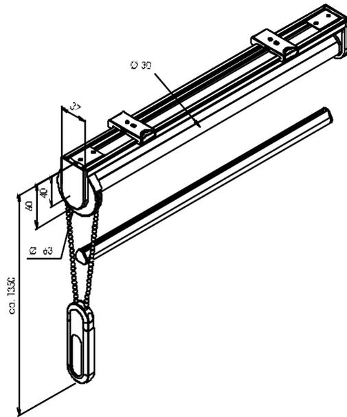
Bedienung rechts mit kurzem Träger
