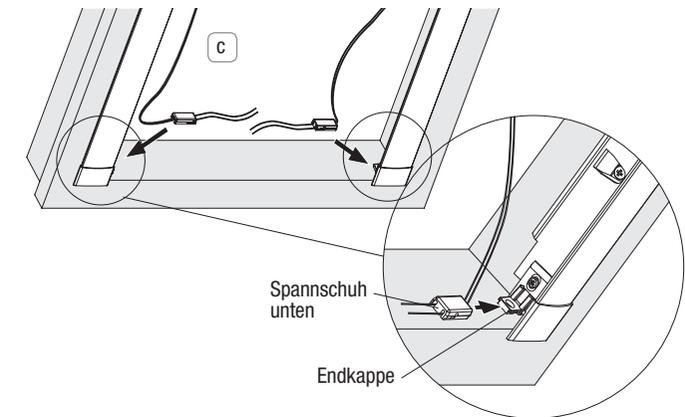
**Nach der Funktionskontrolle** können die überstehenden Schnüre abgeschnitten werden.
