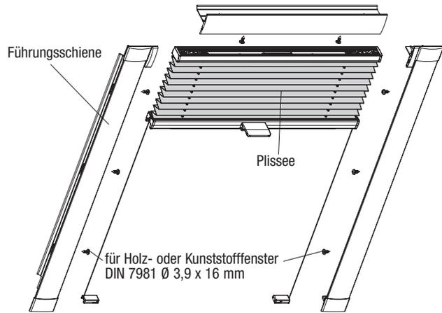
**Hinweis:** Bei dem Fenstertyp GGU älterer Bauart mit 105° Falz müssen die beigelegten Distanzstücke in die Führungsschienen eingesetzt werden. Distanzstücke im Bereich der Schrauben platzieren.
