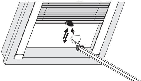
**Arretierung** des Bedienungsprofiles auf der Spannschuhbefestigung.
