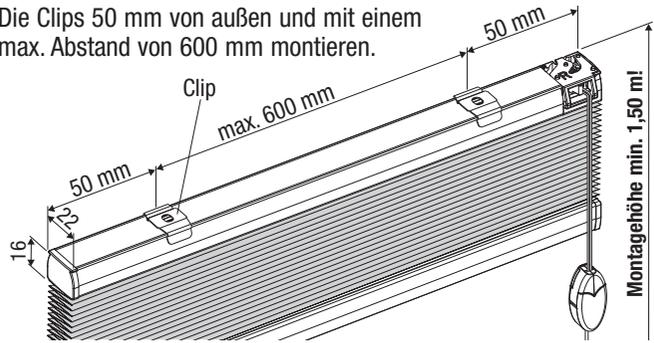
**Hinweis:** Der Clip wird vorzugsweise mit der Lasche nach vorn (Sichtseite) montiert. Der Clip kann mit der Lasche zum Fenster bzw. zur Scheibe **nur** montiert werden, wenn der Abstand zur Schiene **min. 7 mm** beträgt.
