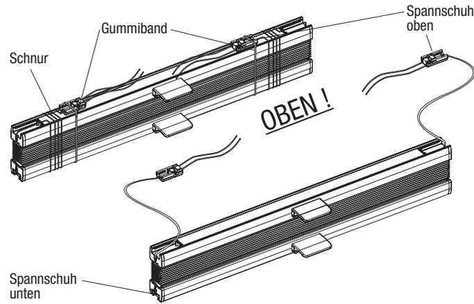
Die oberen Spannschuhe auf die oben montierten Halteplättchen schieben, bis sie einrasten.
