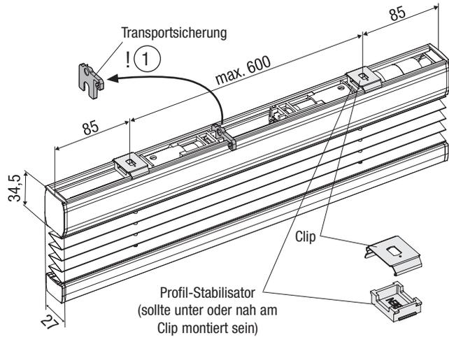
**Montage:** Die Kante des Profils schräg in den Clip (gegenüber der Lasche) einsetzen und dann in den Clip hinein schwenken bis es einklickt.
