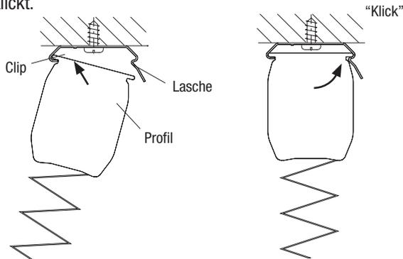
Zur **Demontage** drücken Sie die Lasche des Clips hoch, um das Profil aus dem Clip entnehmen zu können.
