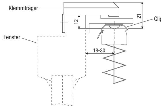
Befestigen Sie den Clip am Klemmträger, bevor Sie diesen montieren.
