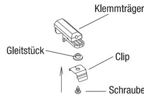
Den Klemmträger mit einem Sechskantschlüssel am Fensterflügel befestigen.
