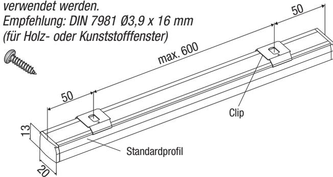
**Montage:** Die Kante des Profils schräg in den Clip (gegenüber der Lasche) einsetzen und dann in den Clip hinein schwenken bis es einklickt.
