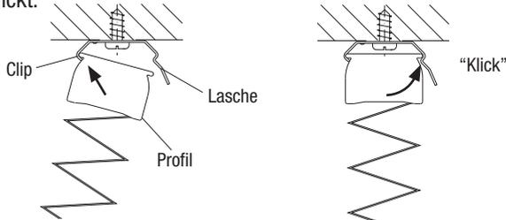
Zur **Demontage** drücken Sie die Lasche des Clips hoch, um das Profil aus dem Clip entnehmen zu können.
