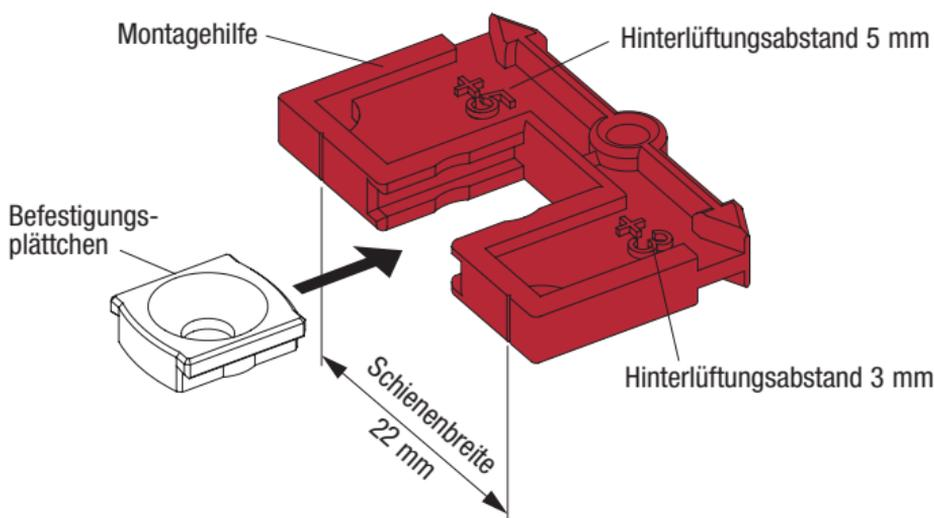
**Montagehilfe auf der Glasleiste positionieren**
